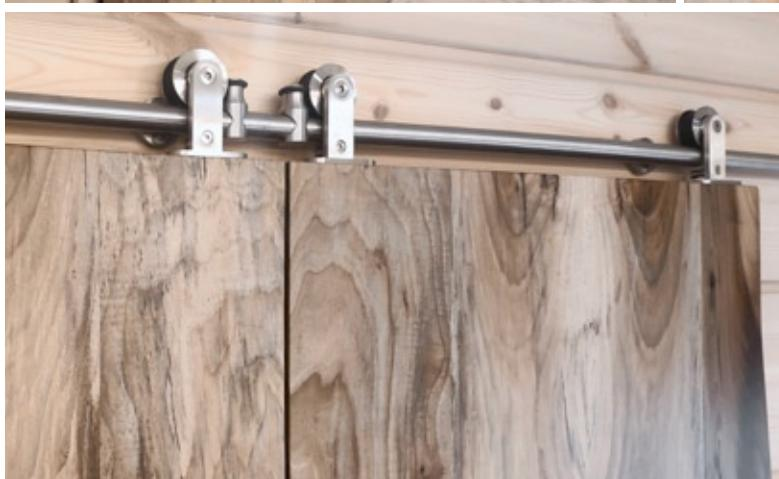
Навесные двери с амбарным механизмом предлагаем из трёх пород древесины: орех, дуб и карагач. Самые шины с роликами изготавливаем в двух вариантах, чёрная сталь и серебристая шлифованная нержавеющая сталь. На роликах устанавливаются резиновые шины для бесшумного движения двери.
