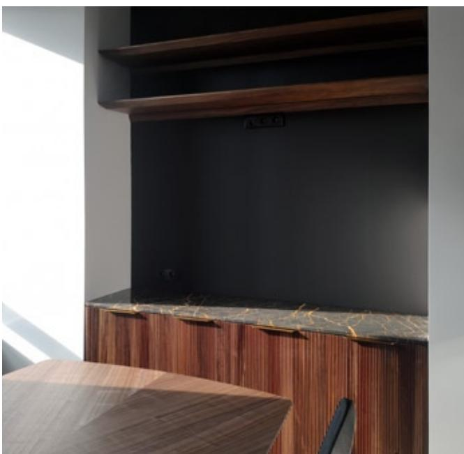
Переговорная выполнена в американском орехе. Столешница изготовлена из фанеры и наборного разнонаправленного шпона радиального ореха. Кромки у столешницы заужены снизу, радиусная форма по всему периметру. В столешницу вмонтированы розетки. Так же в интерьере используются полки с подсветкой и комод с фрезерованными инженерными фасадами и мраморной столешницей.
