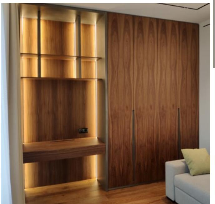
Рабочее место может быть не только удобным, но и красивым. В этой комбинации шкафа и рабочего стола используется шпон американского ореха, массив, олово, напыленное на МДФ. Рабочая поверхность стола изготовлена из фанеры и палубы ореха, выдвижной ящик на всю ширину стола. Панель в рабочей зоне — фрезерованная мелкая волна. Полки заужены с лицевой стороны, в оловянные стойки вмонтирована подсветка.
